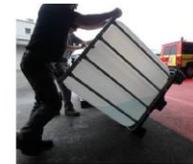
5. Den geschlossenen IBC-Behälter durch Kippen spülen. Anschliessend leeren. Erneut für den Transport resp. für die Wasserabgabe befüllen.
